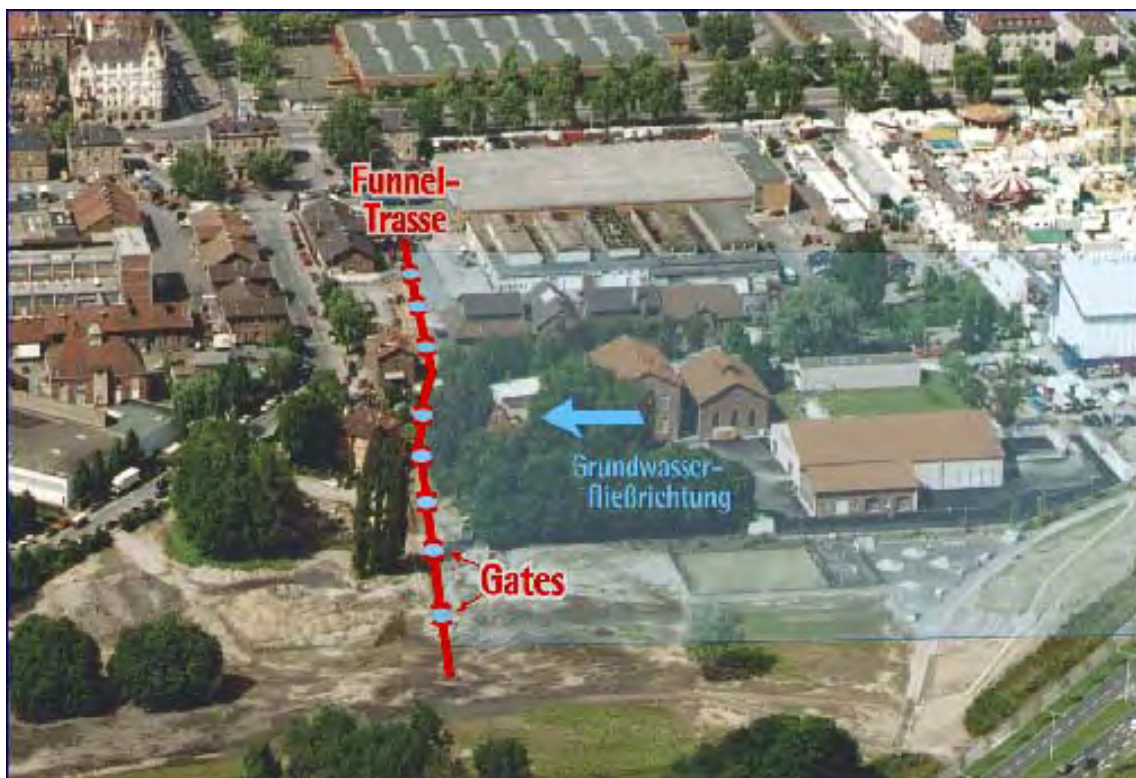
Abbildung 20. Luftbild vom Standort Karlsruhe aus 2001 mit skizzierter Lage und Ausrichtung des Full scale-F&G-Systems mit acht Gates, jeweils befüllt mit Aktivkohle (Bild: Stadtwerke Karlsruhe, Detailinformationen enthalten die Kapitel 4.5.6 und 4.6.1)
