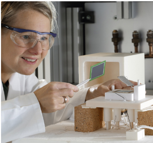
Messtechnik zur elektrochemischen Charakterisierung von SOC's – in keramischen Gehäusen werden Einzelzellen über Zeiträume von bis zu mehreren Tausend Stunden auf ihre Leistung erprobt.
