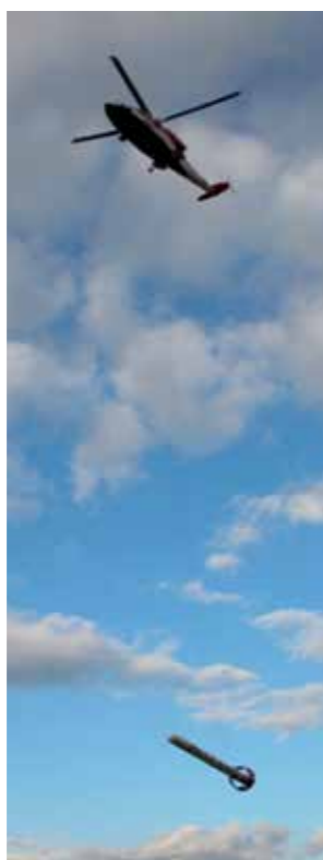
Abb. 1: Der Hubschrauber der BGR mit einer der neuen Flugsonden im Einsatz, Foto: Michael Becken, Westfälische Wilhelms-Universität Münster
