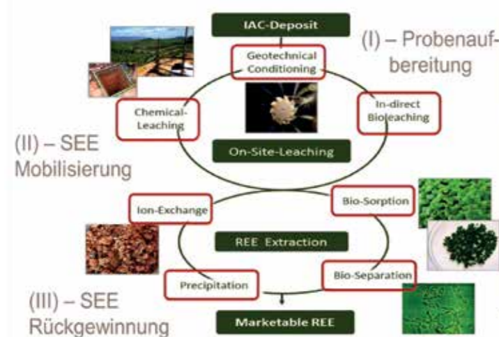
Abb. 1: Verfahrensschritte zur Gewinnung von Seltenen Erden Elementen (SEE) aus Ionenadsorptionstonen (IAC), Quelle: GUB Leipzig
