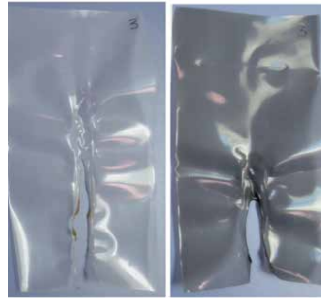
Abb. 1: Test des Flammenschutzmittels: Kunststoffolie additiviert mit Antimontrioxid. In der Kantenbeflammung zeigt sich eine bessere Schutzwirkung durch das wiedergewonnene Antimontrioxid (rechts) im Vergleich zur Neuware (links), Foto: ARGUS Additive Plastics GmbH
