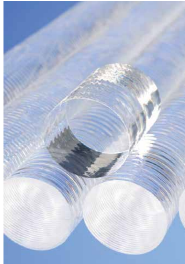
Abb. 1: Optisches seltenerdhaltiges Glas für den Einsatz in der Brillenindustrie, Foto: Fraunhofer ISC
