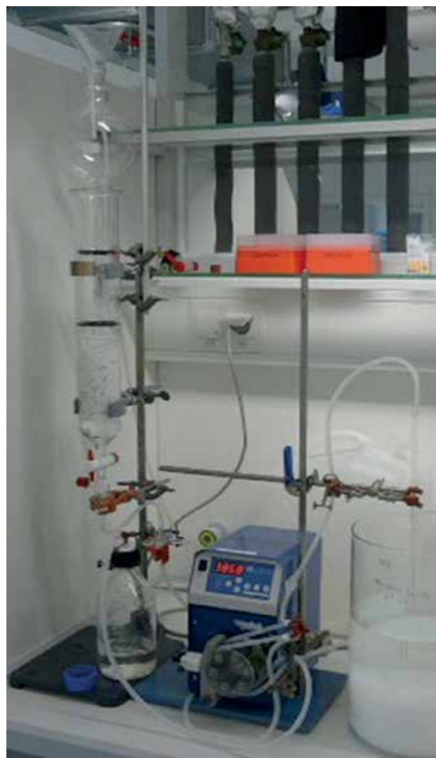
Abb. 2: Laborfiltrationsanlage zur Rückgewinnung von Lanthan mit Hilfe innovativer Adsorbentextilien, Foto: Klaus Opwis, DTNW, Krefeld
