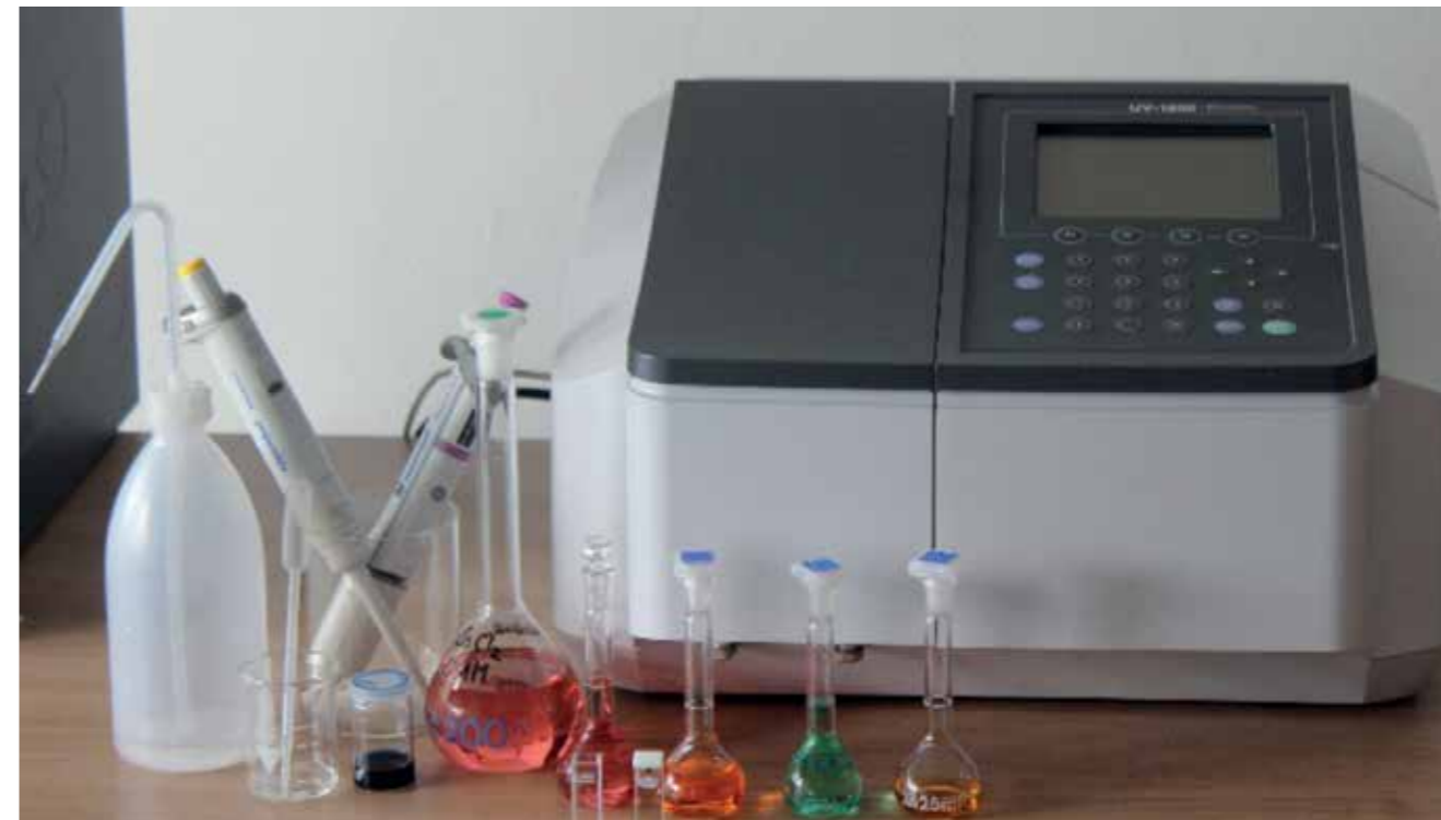
Abb. 2: Messung der Aktivierung mittels UV-Vis, Fotos: RWTH Aachen University, IME
