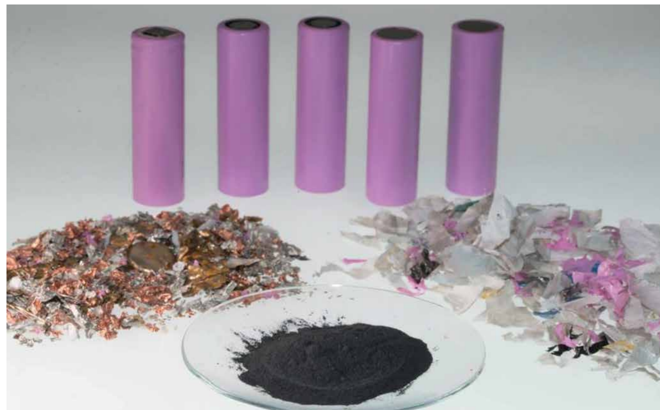
Abb. 1: Zurückgewonnene Materialfraktionen: Metalle (links), Elektrodenmaterial (vorne), Kunststoffe (rechts), Foto: Fraunhofer ISC
