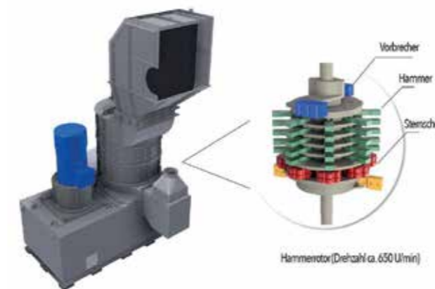
Abb. 3: Shredder-Anlage zur Entstückung der Leiterplatten, Foto: SICON
