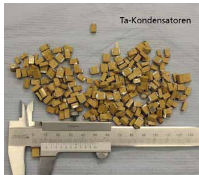
Abb. 1: Manuell demontierte Ta-Kondensatoren zur chemischen Analyse, Foto: IME der RWTH Aachen
