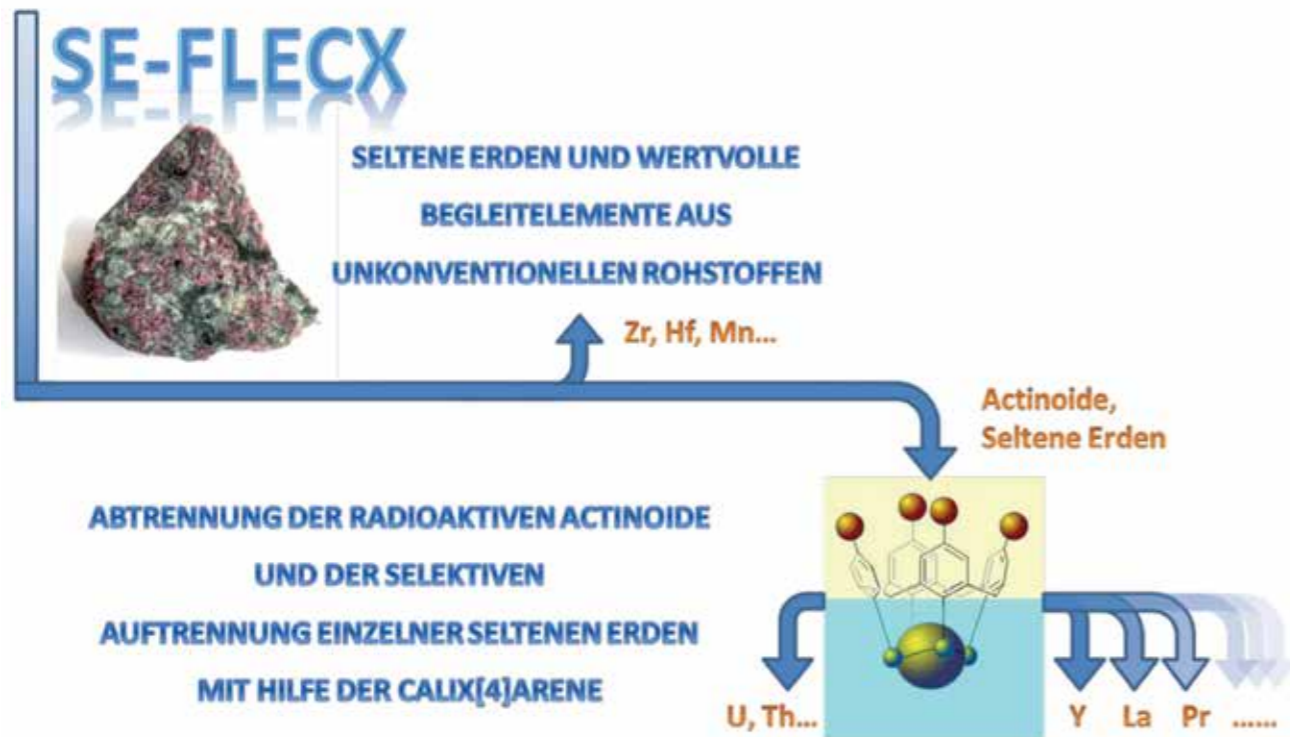
Abb. 1. Gewinnung von Seltenen Erden aus unkonventionellen Rohstoffen unter Einsatz von Calix[4]arenen, Quelle: Helmholtz-Zentrum
