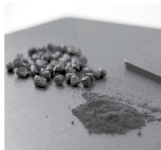
Abb. 3: Hergestellte Bipolarplatten aus Polypropylen-Kunststoff und Graphit bzw. Kohlenstofffaserpulver, Foto: Fraunhofer ICT
