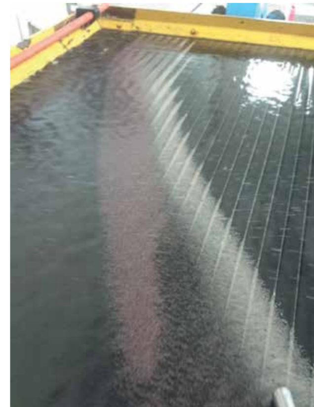
Abb. 2: Sandaufbereitung auf dem Schüttelherd: Schwerminerale (rot) und Quarzsand (weiß) als getrennte Fraktionen, Foto: IFAD, TU Clausthal
