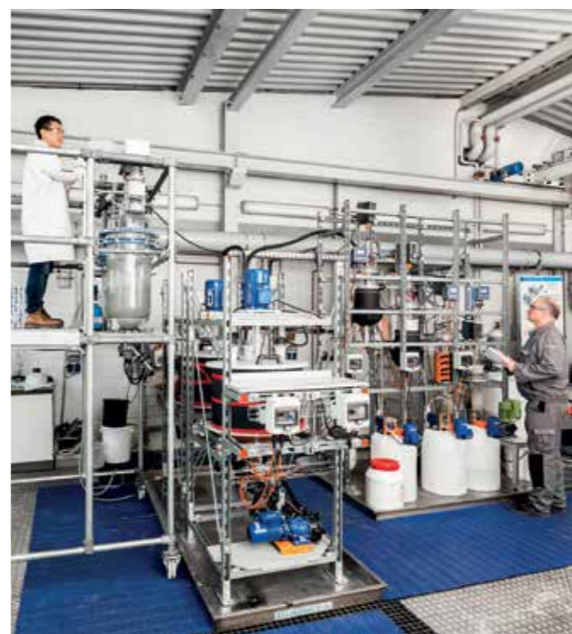
Abb. 1: Ag-Laugungsanlage, Foto: RWTH-IME
