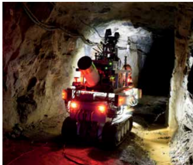
Abb. 1: UPNS4D+ Erkundungsfahrzeug mit Sensorauf- und anbauten in einer Strecke der Reichen Zeche / Freiberg, Foto: RWTH Aachen, IMR
