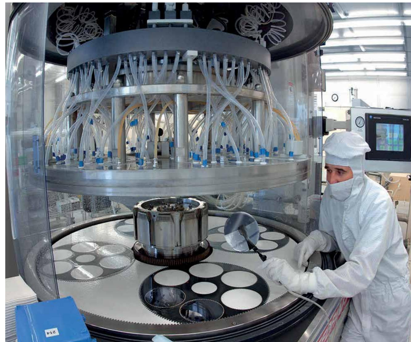
Abb. 1: Beim Polieren anfallende Poliersuspension enthält Gallium in geringer Konzentration. Dieses will „EcoGaIN“ mit neuen Recyclingverfahren wiedergewinnen. Foto: Freiburger Compound Materials GmbH
