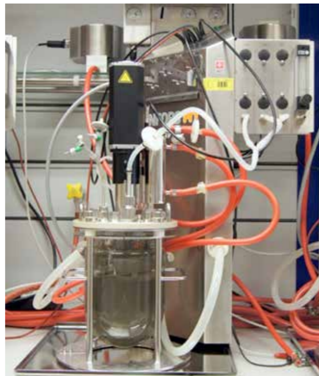
Abb. 2: Bioreaktor zur Laugung des Theisenschlammes, Quelle: TU-BAF-Mikrobiologie
