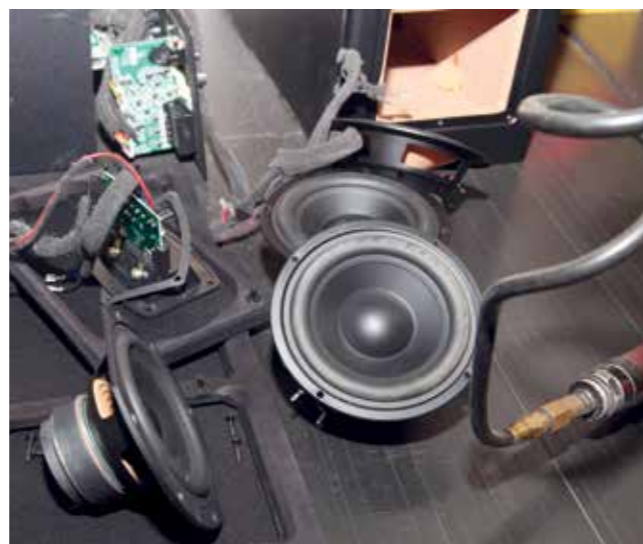
Abb. 1: Manuelle Demontage von Lautsprecherboxen zur Freilegung enthaltener NdFeB-Magnete, Foto: Andre Bertram, CUTEC
