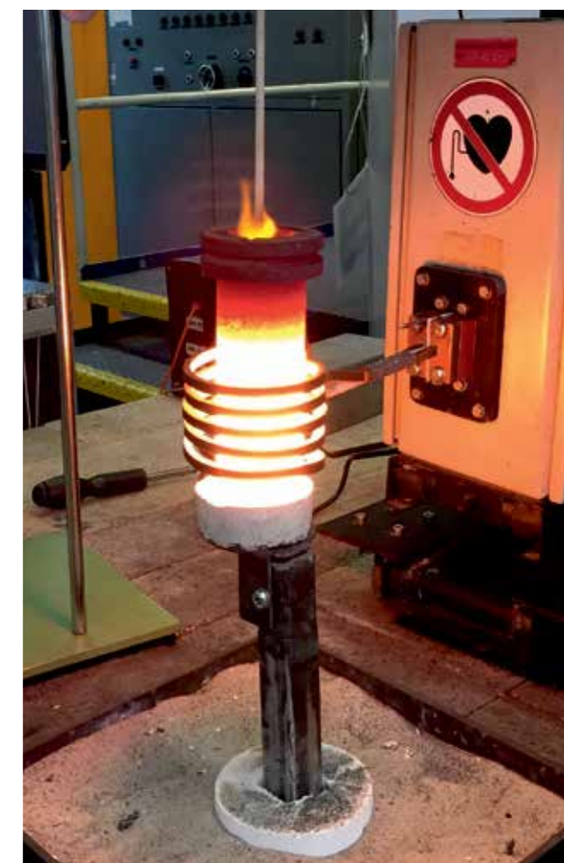
Abb. 3: Reduktionsversuch im Labor, Foto: Dominik Ebert, Universität Duisburg-Essen
