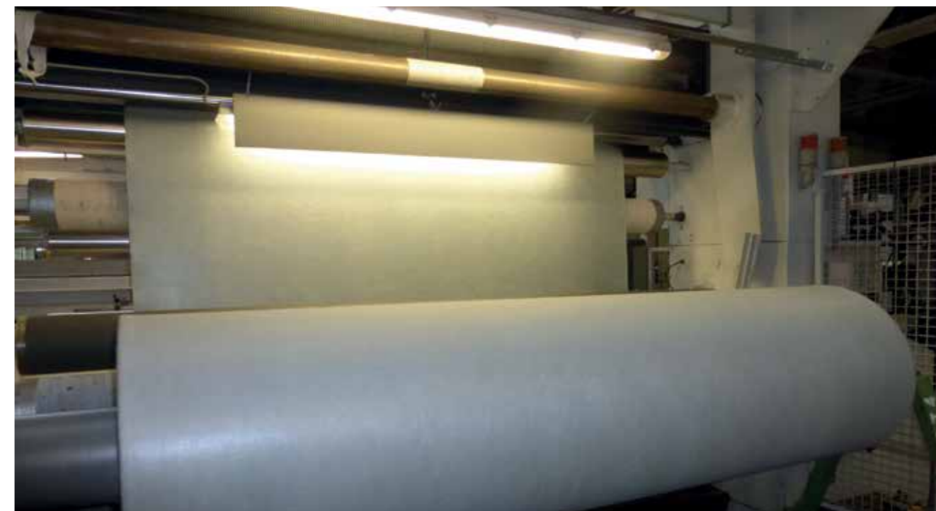
Abb. 3: Einfache und kostengünstige Ausrüstung textiler Materialien mit metallbindenden Polyelektrolyten im industriellen Maßstab, Foto: Klaus Opwis, DTNW, Krefeld
