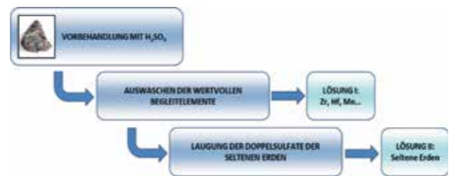
Abb. 3: Das Prinzip der angewendeten Methode zur Gewinnung von Metallen aus Norra-Kärr-Erz., Quelle Helmholtz-Zentrum
