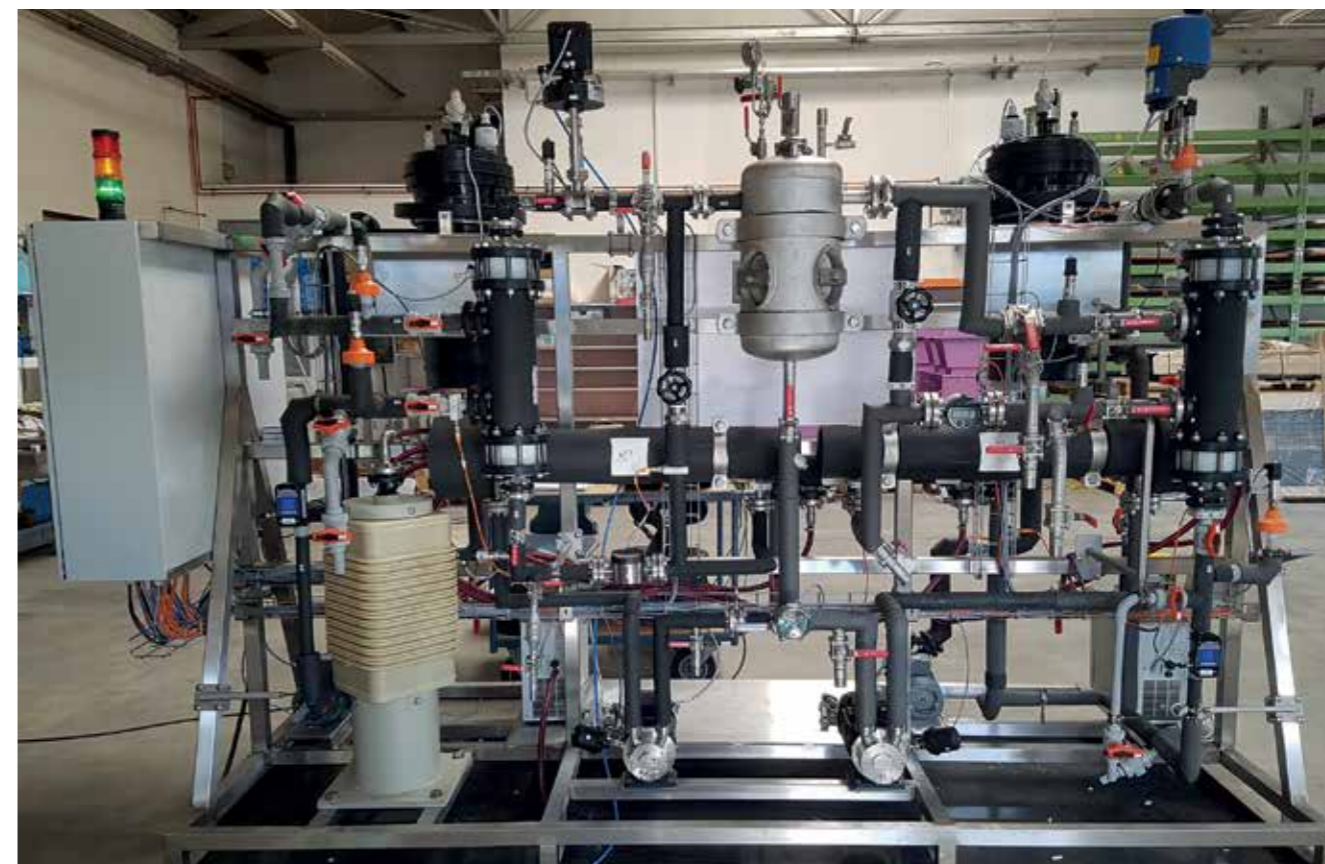
Abb. 2: Entwickelter Demonstrator zur membrangestützten Selektiv-Extraktion, Foto: Andreas Junghans Anlagenbau und Edelstahlbearbeitung GmbH & Co. KG
