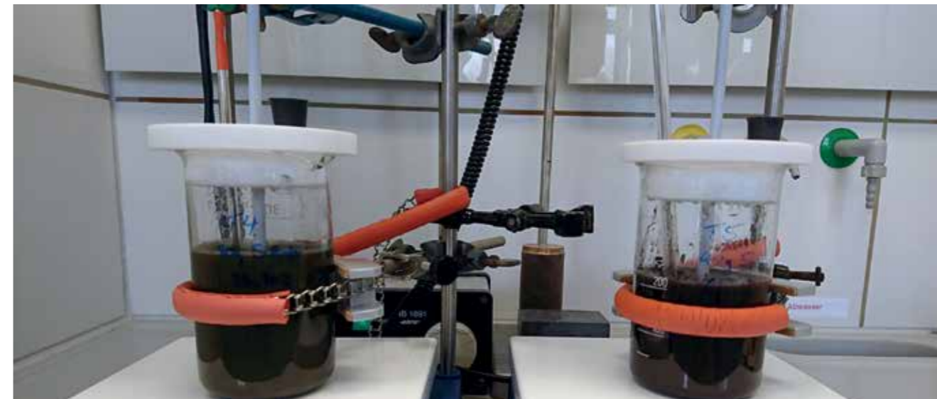
Abb. 2: Laboraufbau der Laugungsversuche, Foto: Fraunhofer UMSICHT
