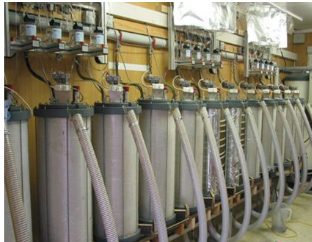
Einstufiger, 30 Liter-Biogasfermenter der Bayerischen Landesanstalt für Landwirtschaft mit automatischer Gaserfassung und -analyse
