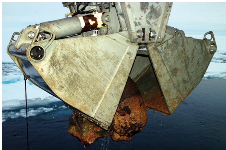
Video-gesteuerter Greifer mit gezielt entnommener Probe an Bord der Polarstern
