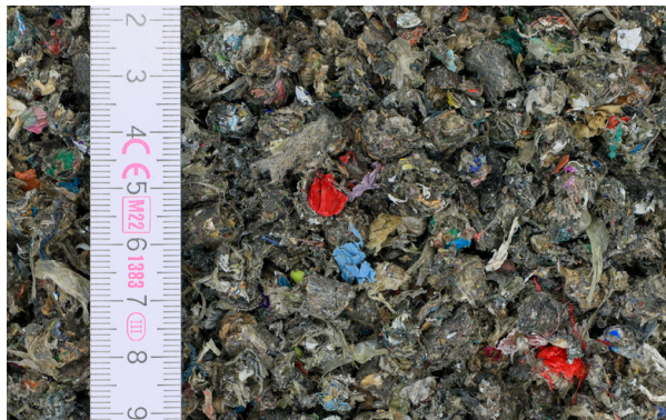
Agglomerierte Folienreste werden im Laborbetrieb eingesetzt.
