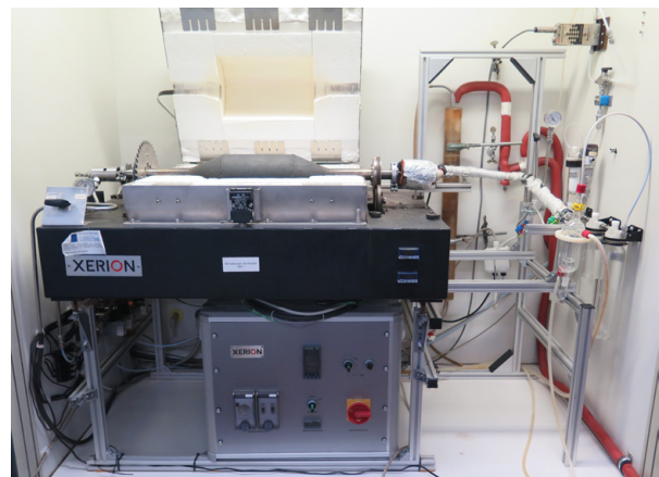
Die „pool-in-loop“-Versuchsanlage: Ein Drehrohrreaktor.
