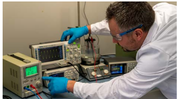
Versuchsaufbau zur Herstellung der TiO 2 -Halbleiterphase mittels Anodischer Oxidation.
