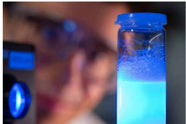
Die Mischung eines Kohlenstoffnitrids mit Wasser wird mit LED bestrahlt.
