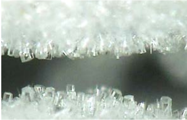
Zeolith-Aufkristallisation der Firma Fahrenheit: Kompakte Adsorbenschichten auf metallischem Träger
