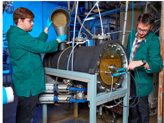
Hochdruck-Methanreaktor am Institut für Agrartechnik der Universität Hohenheim.
