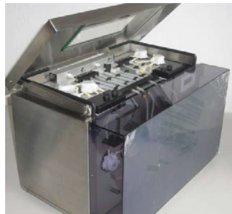
EloTrace – automatische Probenvorbereitung und elektrooptische Messung von Bakterienkulturen
