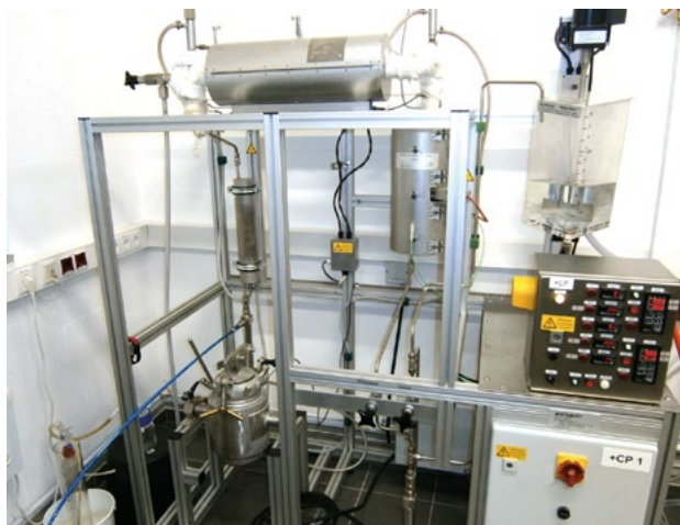
Kontinuierlicher hydrothormaler Rohrreaktor
