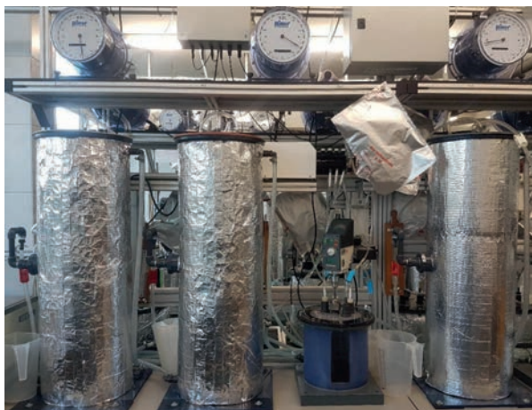
Versuchsstand zur anaeroben Vergärung des HTC-Prozesswassers
