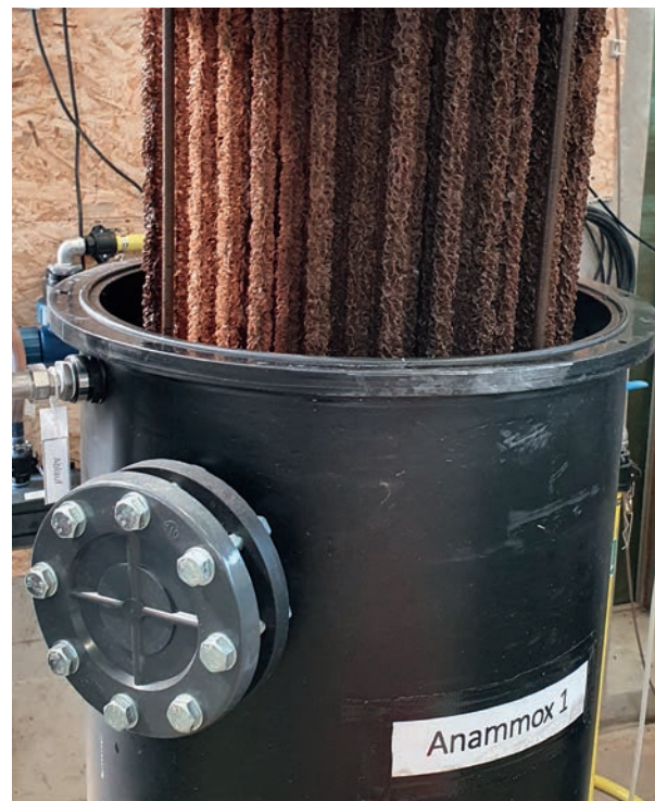
Das MiNzE-Konzept wird in einer Deammonifikationsanlage mit getauchtem Festbett erprobt
