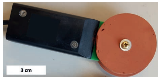
Sensor-Prototyp: Auf einem Glasfaserträger sind mehrere Keramik-scheiben und die Messelektronik angeordnet
