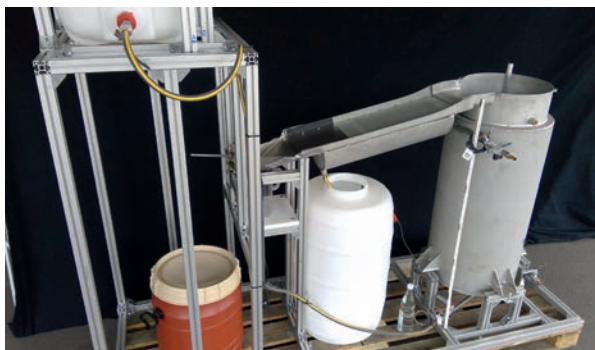
Laboranlage (im Aufbau, noch ohne Presse): Rechts Kristallisationsapparat mit Überlauf; Siebblech-Rutsche zum Abtropfen des Eisbreis; Behälter für Meerwasser, Sole und Süßwasser
