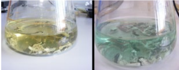
Versuchsstadien beim Bioleaching von galvanisierten Zerteilen eines Fahrzeugs.
