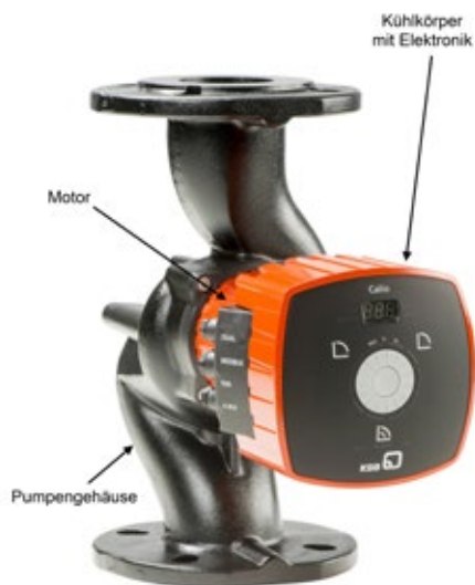
Hauptkomponenten von Umwälzpumpen.
