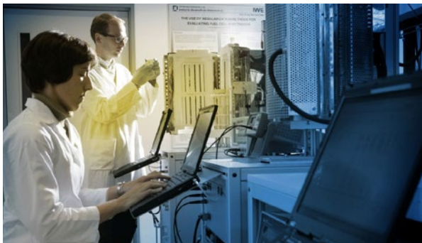
Messtechnik zur elektrochemischen Charakterisierung von SOFCs – in den Prüfständen werden Einzelzellen über einen Zeitraum von bis zu mehreren tausend Stunden betrieben.
