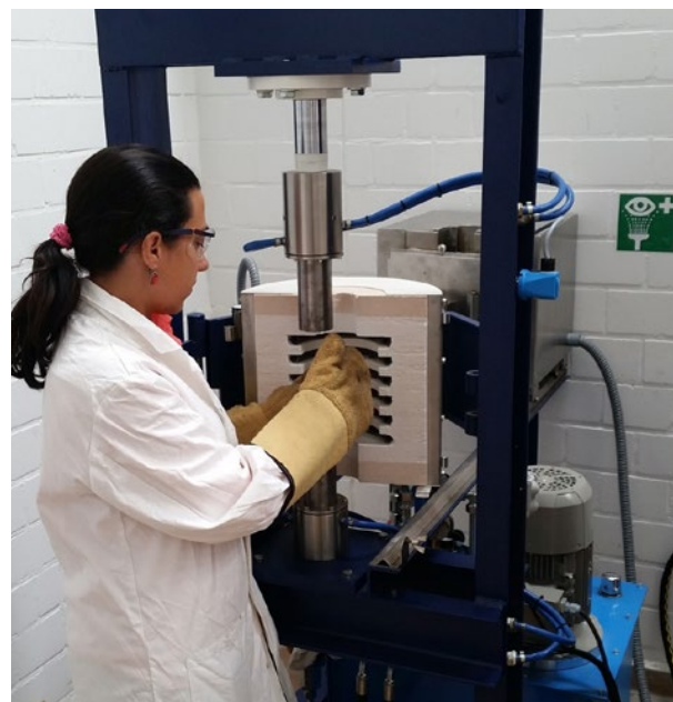
Eine Mitarbeiterin bedient die hydraulische Heipresse. Hiermit werden die Pulver-Polymer-Mischungen unter Temperatureinwirkung zu einem Pressling verdichtet.
