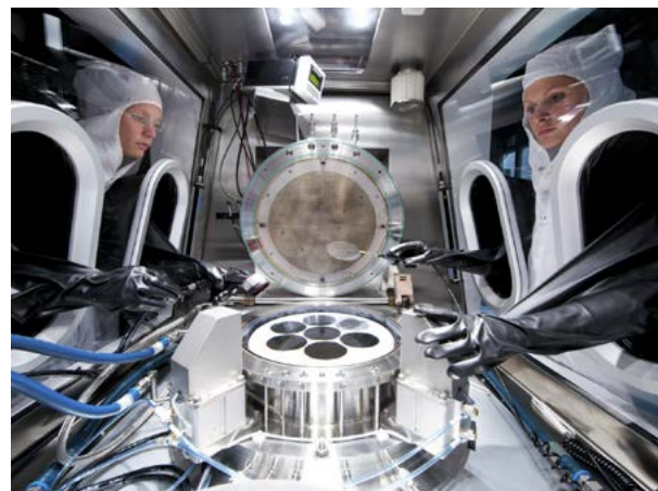
CRIUS Epitaxieanlage des Verbundpartners Aixtron, welche am Fraunhofer ISE zur Entwicklung der III-V Halbleiter-Schichtstrukturen auf Silizium genutzt wird.
