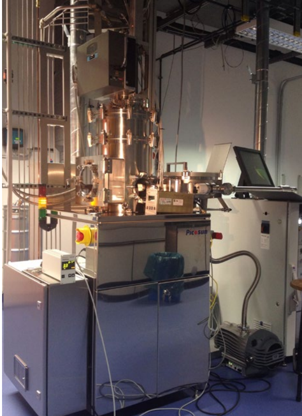
Atomlagenabscheidungs-Anlage für die Herstellung dünner Metalloxid-Schichten
