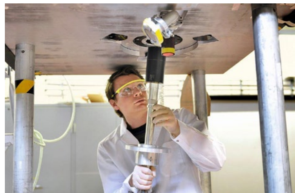
Vorbereitung einer Membranprobe für die Feldgradienten- Kernspinresonanzspektroskopie: Einführen des Probenkopfs
