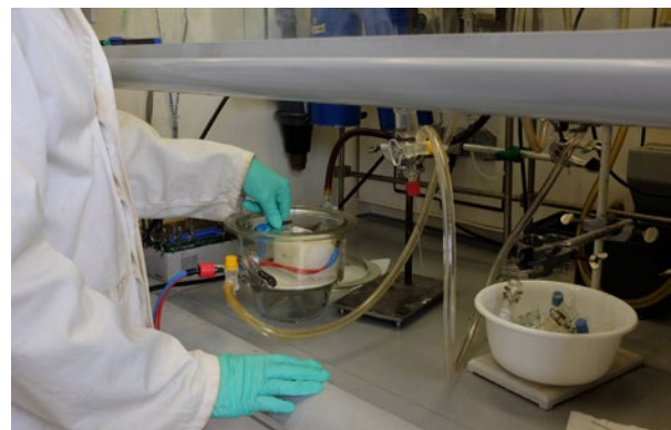
Forschende bauen einen Batterieversuch ab. Ionische Flüssigkeiten sind in Glasgefäßen zu sehen (rechts).
