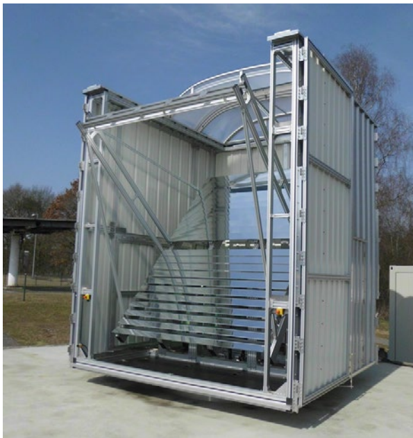
Teststand SoCRatus für photokatalytischer Systeme mit Solarstrahlung
