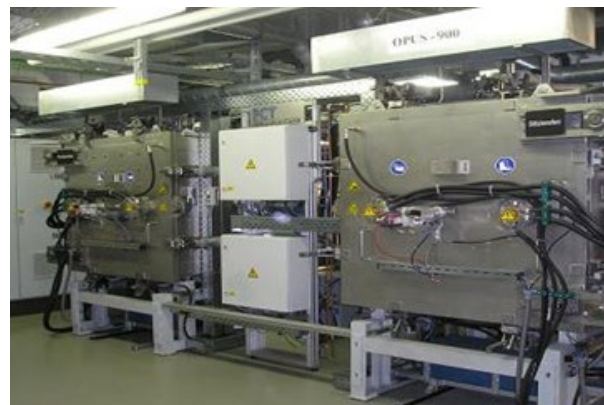
Hochtemperaturöfen zur Herstellung keramischer Hochtemperaturkomponenten im Institut für Bauweisen und Strukturtechnologie in Stuttgart
