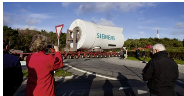
Transport des Turmkopfes einer Windkraftanlage inklusive des Generators
