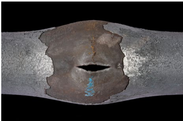
Schaden an einem Überhitzerrohr für Dampfkraftwerke im Laborversuch. Es ist eine örtliche Schädigung und Aufweitung des Rohrs durch lokale Korrosion und den hohen Dampf-Innendruck der Rohrleitung. Schließlich kommt es zur Bildung eines Risses.
