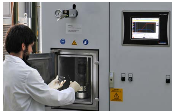
Feldunterstütztes Sintern zum Verdichten der Verbundwerkstoffe
