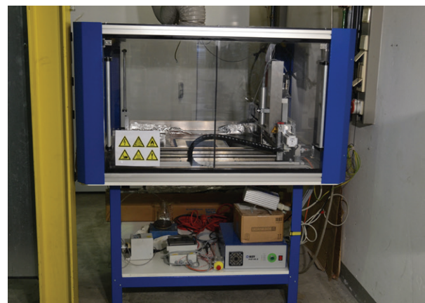
In einer Sprühbeschichtungsanlage werden katalytisch aktive Substanzen auf Elektroden aufgetragen
