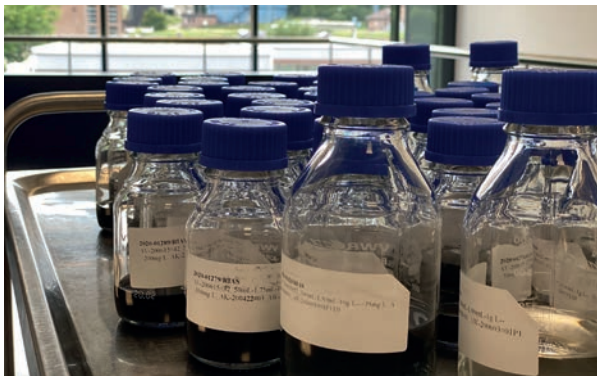
Wie gut die ressourcenschonenden Aktivkohlen Spurenstoffe aus Abwässern entfernen können, wird in Laborversuchen ermittelt
