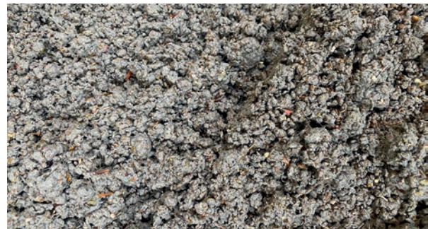
Auf Kläranlagen wird aus dem Abwasser Siebgut für die Herstellung ressourcenschonender Aktivkohlen gewonnen
