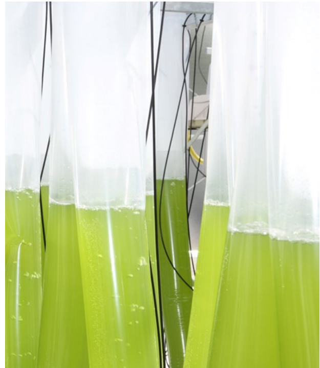
Photobioreaktoren im Jülicher Algen-Science-Center
