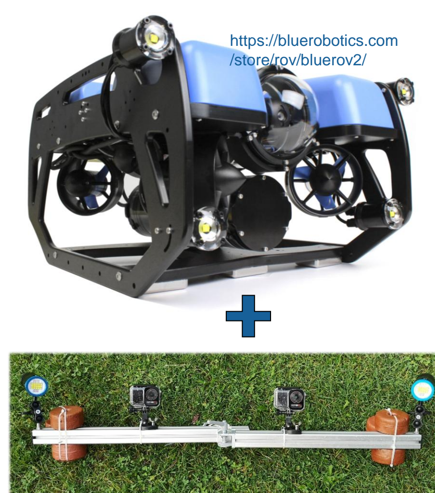
Tauchroboter und Testversion eines Kamerasystems (Quelle: SDC –TUBAF)
