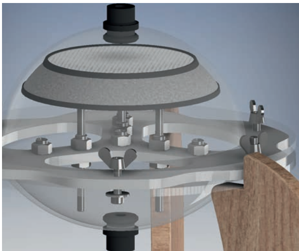
Prüfstand zur Untersuchung der Filtrationsleistung unterschiedlicher Glaskugelkonfigurationen
