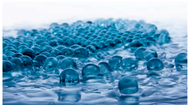
Das Projekt SpheroFilt setzt Glaskugeln als neues Filtermedium zur Wasseraufbereitung ein
