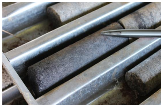
Abb. 1: Bohrkern von PGM-haltigem Erz, Thaba-Mine, Südafrika.
