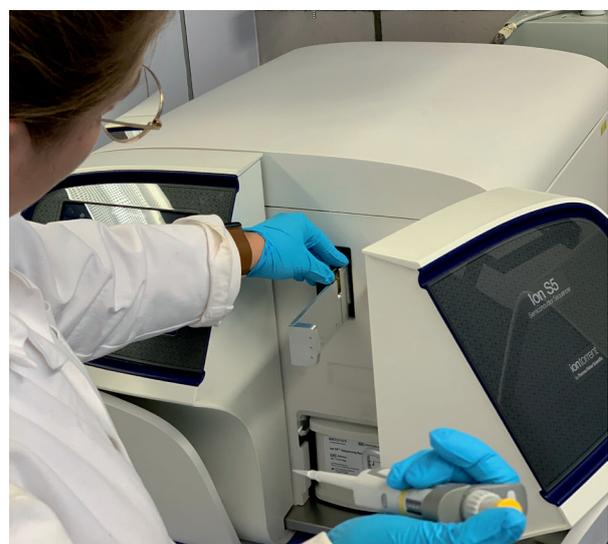
Virus-RNA aus einer Abwasserprobe wird in den Sequenzierer eingesetzt
