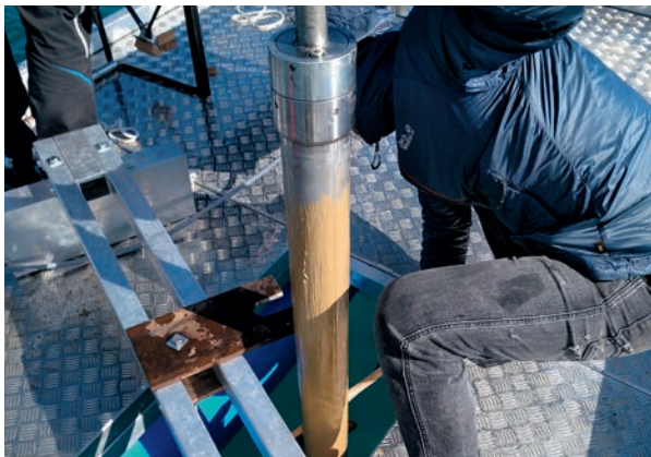
Forschende entnehmen in 35 Meter Tiefe einen Sedimentkern aus der vier bis sechs Meter dicken Feinsedimentschicht
