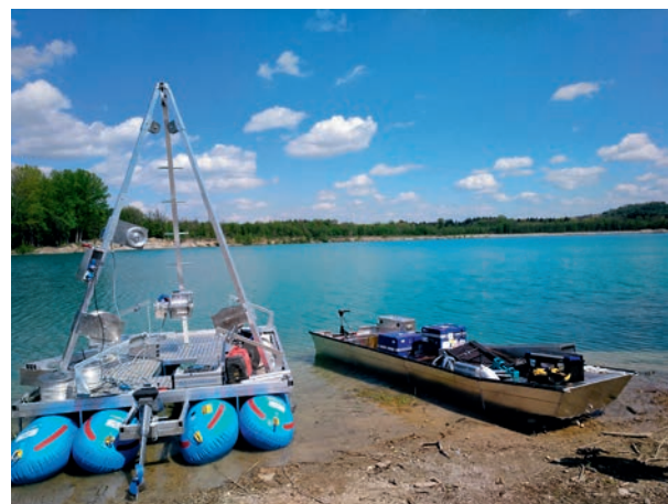
Bohrplattform und Beiboot mit zusätzlicher Ausrüstung: Mit Tiefenbohrungen wollen die Forschenden gemessene Daten überprüfen.
