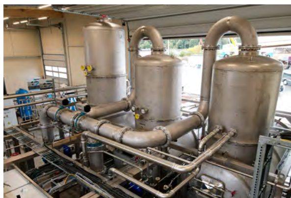
Im Projekt STEAM wird das Verfahren der fraktionierten Eindampfung weiterentwickelt. Das Bild zeigt eine dreistufige Anlage zur fraktionierten Eindampfung.
