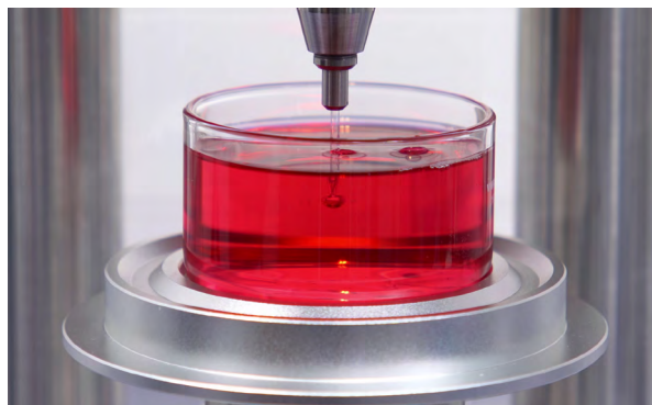
Das Bild zeigt ein herkömmliches Messverfahren mit Blasendrucktensiometrie. Die dabei gemessene Oberflächenspannung dient als Grundlage zur Optimierung der Reinigungsleistung in Prozessbädern und zur Steuerung ihres Recyclings.
