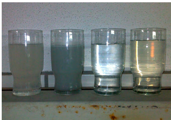
Bild aus Recyclingversuchen in der Vorwäsche einer industriellen Wäscherei: Von links: Rohwasser, Konzentrat, Ultrafiltrat (kaum Tenside), Mikrofiltrat (viele Tenside).
