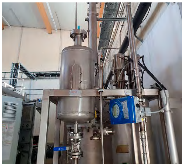
Rektifikationskolonne in der Anlage: Durch den Prozessschritt der Rektifikation kann besonders reines Ammoniakwasser erzeugt werden.
