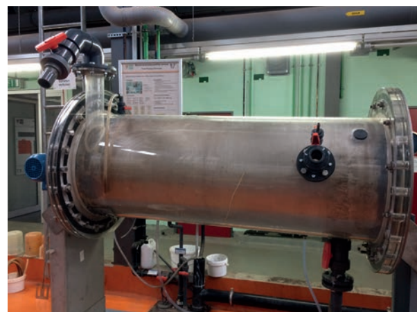
In einem Zylinderspaltreaktor wird der kombinierte Flockungs- und Pelletierungsprozess erprobt
