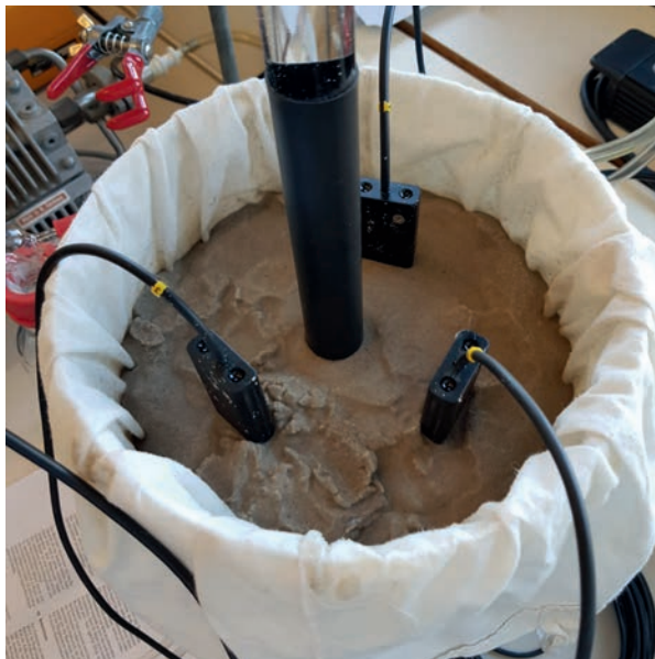
Versuchsaufbau zur Bodenfeuchtemessung in Sand mit Sensor-Prototypen und einem kommerziellen Tensiometer als Vergleich
