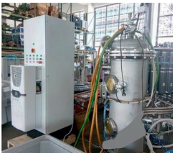
Die Forschenden testen das neue Verfahren im Ultraschallreaktor
