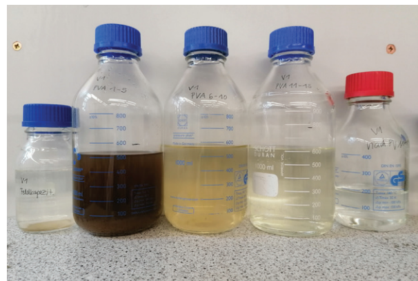
Reinigungslösungen nach Bodenspülung: Die Lösungen enthalten aus dem verunreinigten Boden herausgelöste PFAS.
