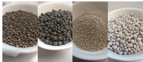
Verschiedene Trägermaterialien für Katalysatoren aus Blähton und Blähglas werden auf ihre Schwimmfähigkeit erprobt; links unbeschichtet und rechts mit Titandioxid beschichtet.
