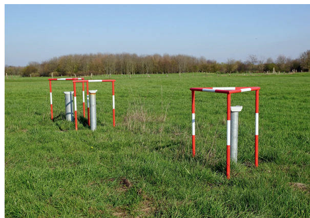
Beispiel einer Grundwassermessstelle. Das im Projekt RISK_Plus entwickelte Softwarewerkzeug soll künftig eine Planung der Probennahmen je nach ermitteltem Risiko ermöglichen.
