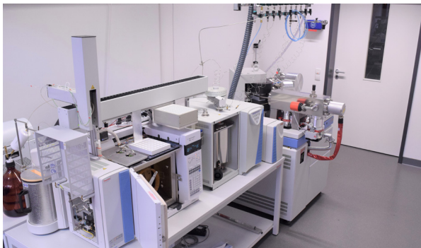
Die Isotopenanalyse erfolgt an einem Gaschromatographen gekoppelt mit einem Isotopenverhältnismassenspektrometer
