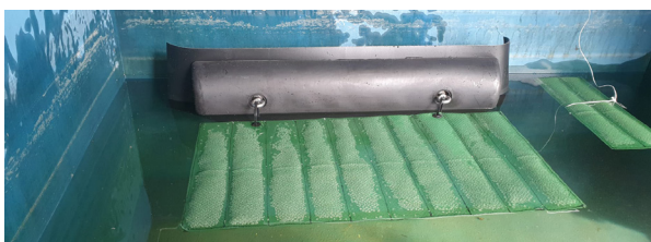
Erster Demonstrator einer Ölsperre kombiniert mit dem schwimmfähigen photokatalytischen Material
