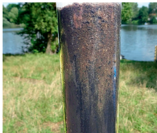
Sedimentkern nach Behandlung mit dem Schäfersee-Verfahren. Der ursprünglich schwarze Faulschlamm ist im oberen Bereich deutlich sichtbar farblich verändert.
