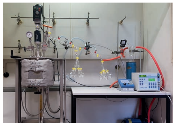
Laborreaktor mit angeschlossener Kondensationseinheit für das chemische Recycling von Polystyrol
