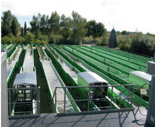
Fließ- und Stillgewässersimulationsanlage des Umweltbundesamtes in Marienfelde
