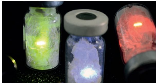
Fluoreszenzmarker sollen eine bessere Sortierung von Kunststoffverpackungen ermöglichen.
