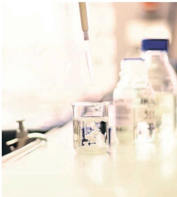
Ausfällen der Terephthalsäure (TPA) aus gelöstem PET
