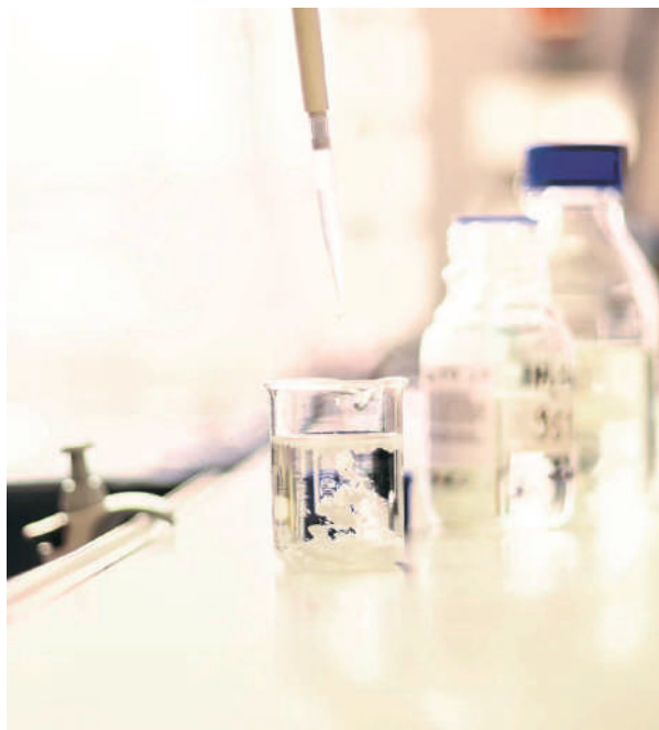
Ausfällen der Terephthalsäure (TPA) aus gelöstem PET
