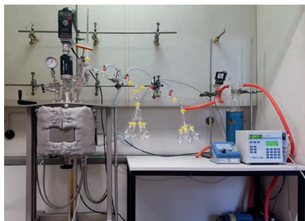
Laborreaktor mit angeschlossener Kondensationseinheit für das chemische Recycling von Polystyrol
