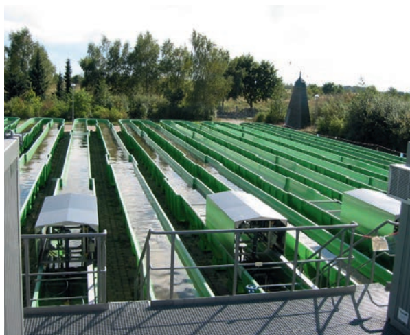
Fließ- und Stillgewässersimulationsanlage des Umweltbundesamtes in Marienfelde
