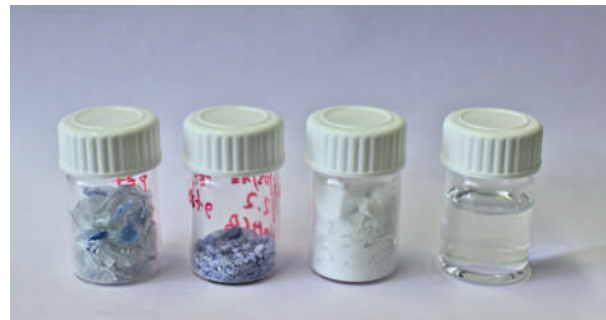
Vom PET zu seinen Grundbausteinen Terephthalsäure (TPA) und Monoethylenglykol (MEG)
