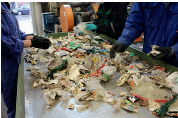
Eine Polystyrolfraktion aus dem Dualen System wird händisch nachsortiert.
