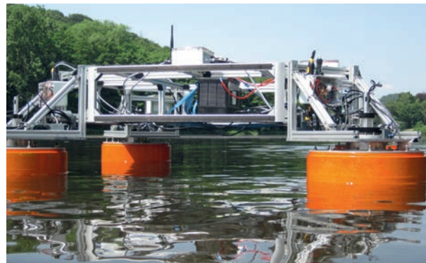
Wie und warum lagern sich die Sedimente um? Um dies herauszufinden, tastet der „Hydrocrawler“ den Grund des Bodensees mit Sensoren ab.
