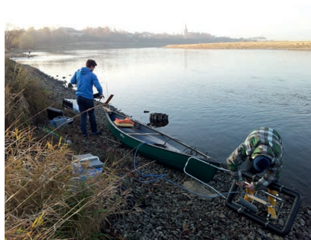
Das Messboot ist so klein, dass man mit ihm auch kleine Fließgewässer in ihrem Längsverlauf untersuchen kann.
