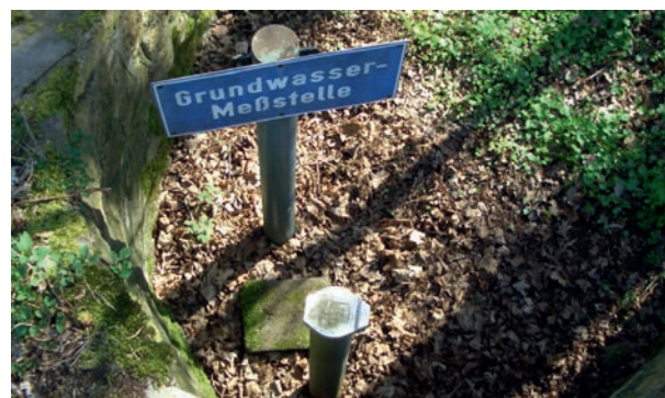
Um die Qualität des Grundwassers zu überwachen, werden an verschiedenen Stellen Wasserproben entnommen.
