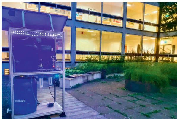
Der Campus-Water-Hub zur Regenwasseraufbereitung an der Universität Hannover ist mit Aktivkohle- und Membranfilter sowie UV-Desinfektion ausgestattet.
