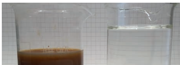
Eine Spülwasserprobe vor und nach der Membranfiltration
