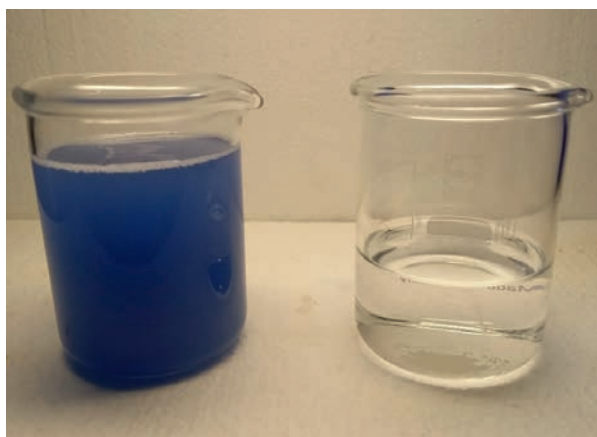
Blauefärbtes Abwasser aus der Handtuchwäsche im Vergleich mit einer Abwasserprobe nach keramischer Membranfiltration
