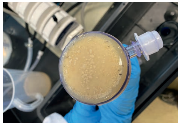
Sulfatausfällungen an einem klassischen Hohlfaser-Membranmodul
