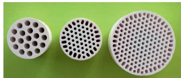
Keramische Membranen mit verschiedenen Geometrien werden zur Reinigung salz- und organikhaltiger Wässer eingesetzt (Außendurchmesser von links nach rechts: 41 Millimeter sowie 25 und 25 Millimeter).
