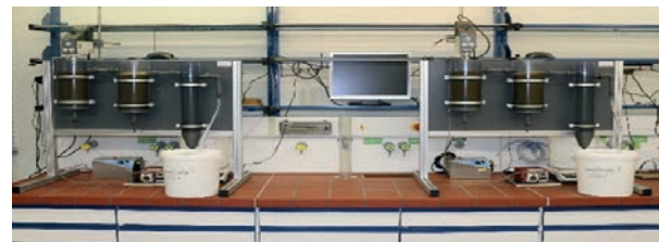
In Laborversuchen wird die biologische Behandlung industrietypischer Abwässer untersucht.
