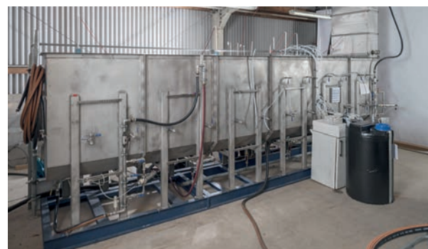
In einer Pilotanlage an der TU München werden die Verfahren zur geplanten Wasserwiederverwendung getestet.
