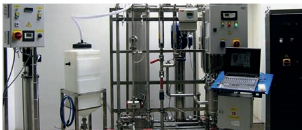
In Pilotfiltrationsanlagen erproben Forscher die keramischen Membranen an Prozesswässern.
