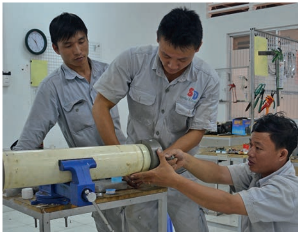
Montage einer Umkehrosmose-Membran im vietnamesischen Unternehmen SDVICO
