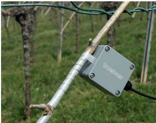
Der neue kapazitive Bandsensor erfasst den Wassergehalt des Stammes einer Pflanze.
