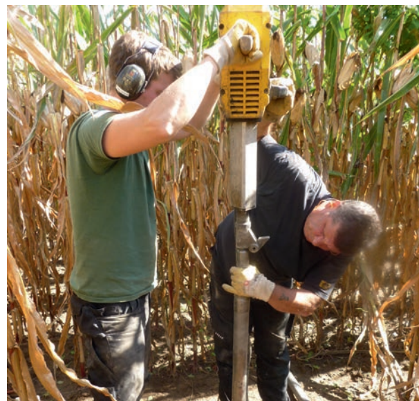
Forscher nehmen Proben, um das Boden- und Schadstoffprofil in der Vertikalen aufzunehmen.
