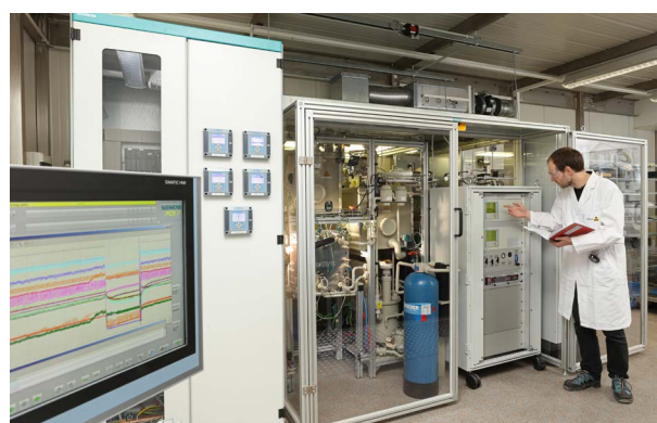
Der vollständig automatisierte CO 2 -Elektrolyseur erzeugt Kohlenmonoxid und liefert mit Wasserstoff die Hauptnahrung für die Bakterien im Bioreaktor.
