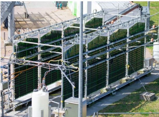
Kultivierung von Mikroalgen unter Freilandbedingungen im Technikumsmaßstab
