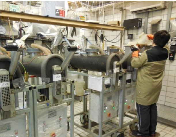
Hydrolyse-Fermenter der Bayerischen Landesanstalt für Landwirtschaft während der Fütterung.
