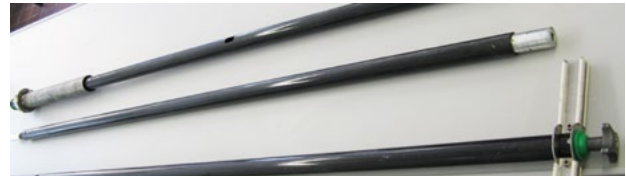
Lanzensteckmodule zur Messung und Probenahme im Kern der Flüssigphase von Biogasanlagen
