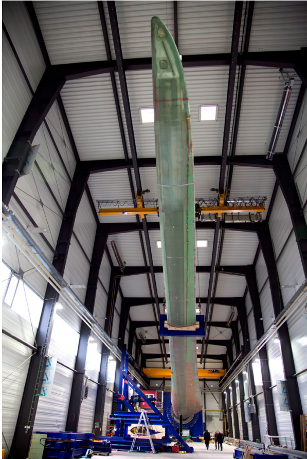
Ein Rotorblatt für Windkraftanlagen in einer 90 Meter langen Halle
