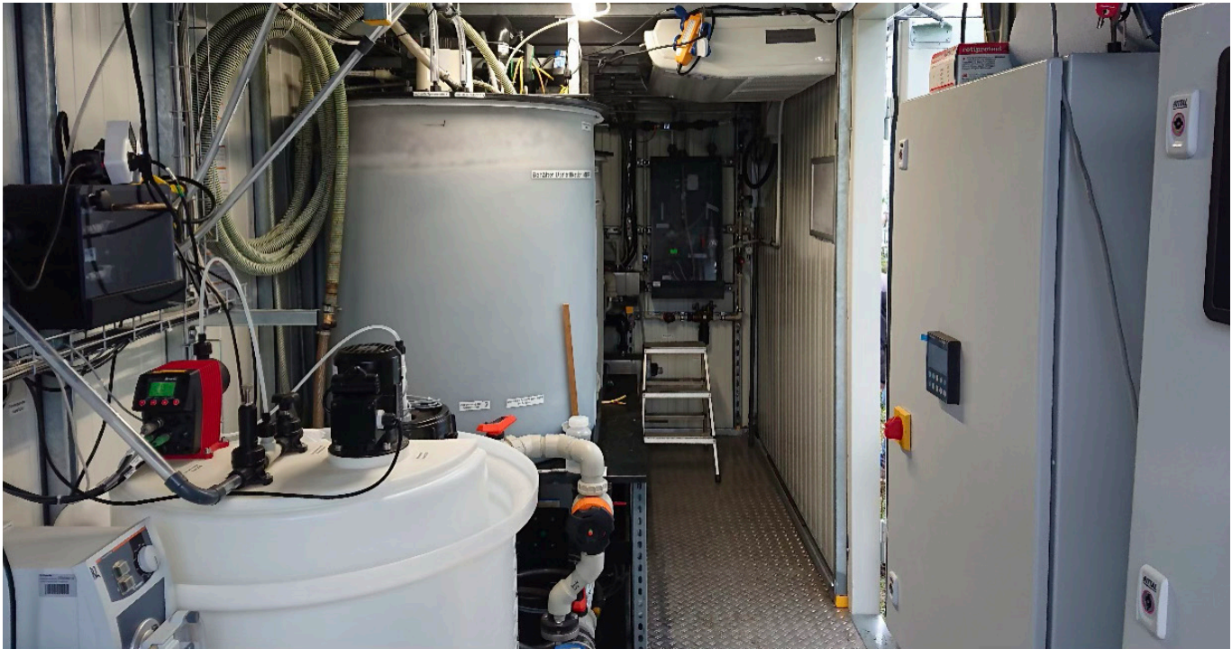
MBBR pilot plant for the degradation of DMAC (Source: Thomas Schalk, TU Dresden, Professur für Siedlungswasserwirtschaft)
