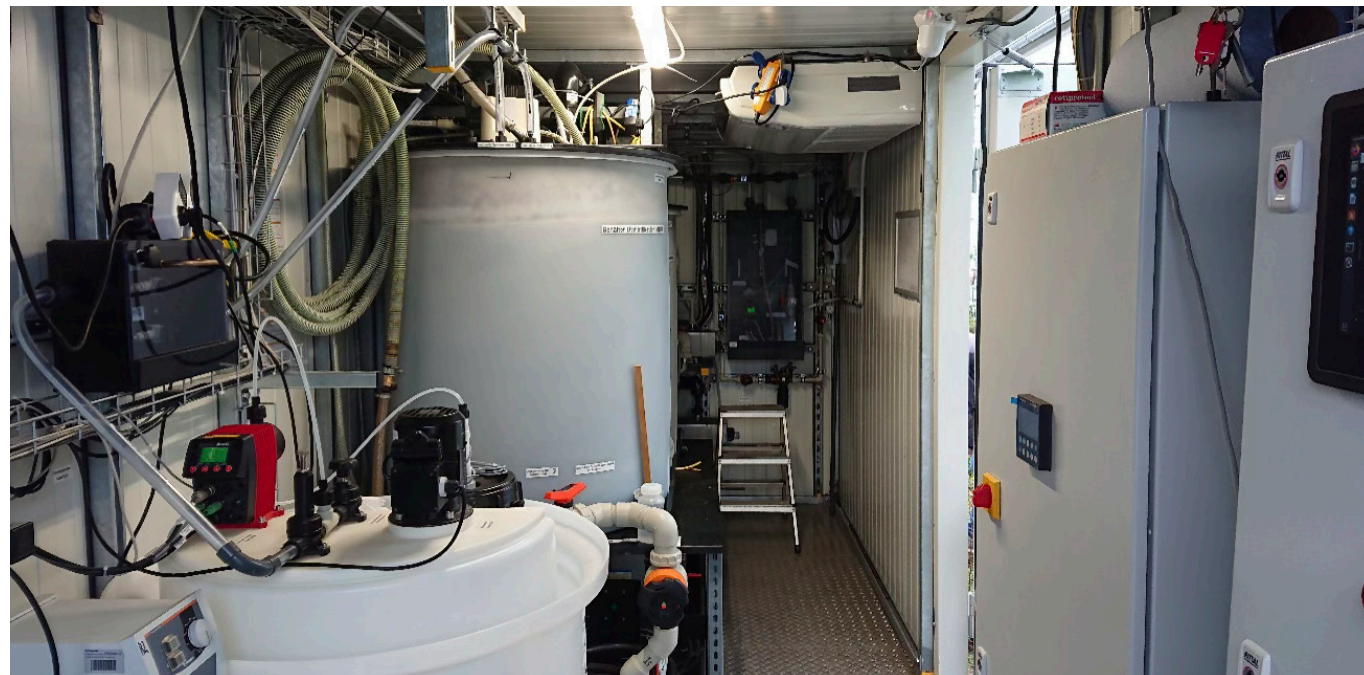
MBBR-Pilotanlage zum Abbau von DMAc (Quelle: Thomas Schalk, TU Dresden, Professur für Siedlungswasserwirtschaft)
