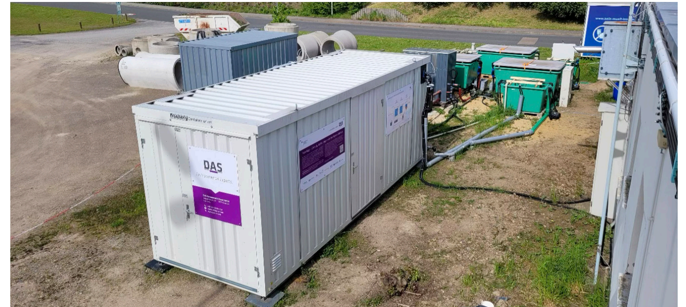
Pilotanlage zum Abbau von DMAc - im Vordergrund: MBBR-Container, im Hintergrund: Vertikalfilteranlage (Quelle: Christian Koch, TU Dresden, Professur für Siedlungswasserwirtschaft)
