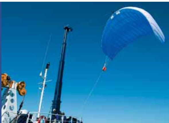
Links: SkySails Zugdrachen-System auf dem Küstenschiff „MS Beaufort“. Rechts: Die Illustration zeigt den Einsatz des Systems auf Frachtschiffen.
