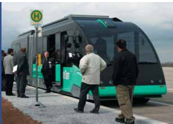
Links: Versuchsfahrzeug AutoTram®. Erster Einsatzort des „DockingPrinzips“. Rechts: Wichtiges Element des neuartigen Antriebskonzepts ist ein Bombardier* MITRAC® Energy Safer.
