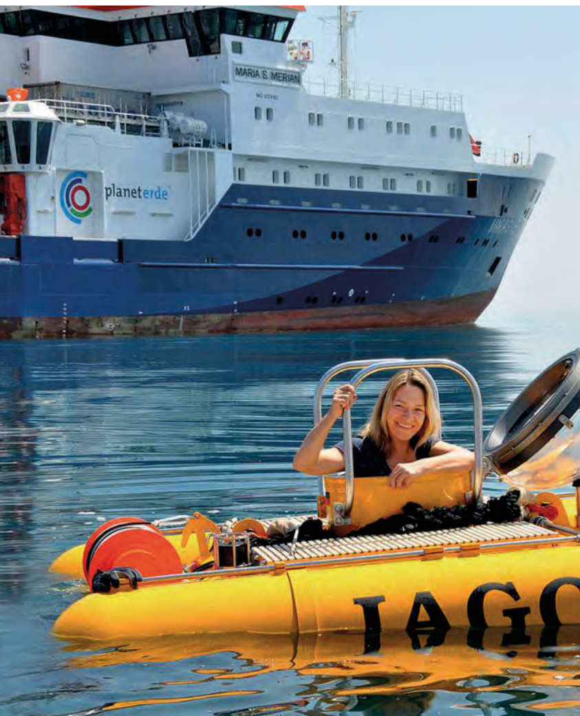
Das bemannte Unterwasserfahrzeug JAGO kann bis zu 400 Meter tief tauchen. Es wird zur Erkundung und Erforschung aquatischer Systeme und Lebensräume eingesetzt.
