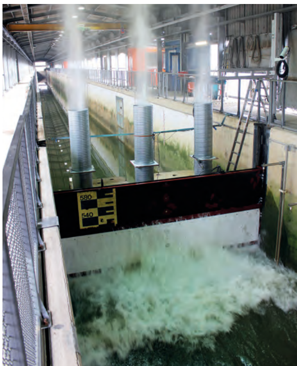
Das Modell eines Wellenkraftwerkes wird im Großen Wellenkanal des Forschungszentrums Küste in Hannover getestet.
