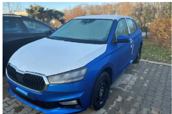
Abdeckmaterialien aus Polypropylen (PP) an Fahrzeugen.
