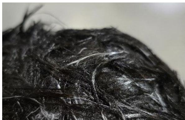
Naturfasern können für Prepregs genutzt werden.
