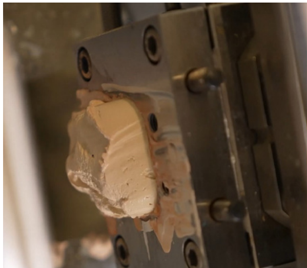
Reaktionsprodukt der Depolymerisation von Textilien.
