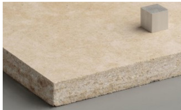
In Gipsfaserplatten sollen Alttextilien eingearbeitet werden.
