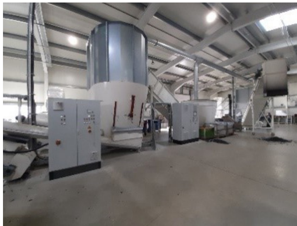
Schredder- und Mahllinien für die Rückgewinnung von Polyester.
