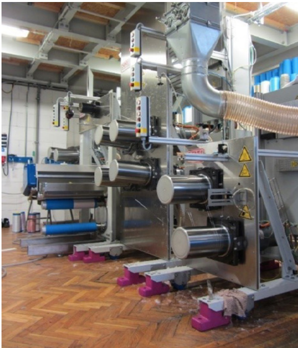
Schmelzspinnanlage zur Herstellung von PP-Garn.
