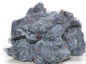
Reißfaser nach der mechanischen Behandlung zum Recycling.
