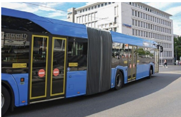
Faltenbälge müssen hohen Kräften und Witterungseinflüssen standhalten.
